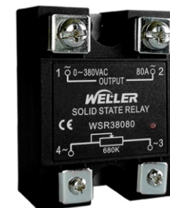
产品配有透明保护罩 (电位器控制调压范围0-380VAC)
