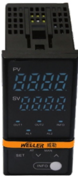
仪表型号为WL118型 面板48*96mm，开口45*92mm，插入深度110mm (96*48mm)
