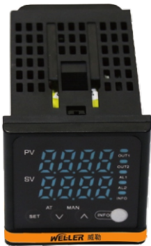
仪表型号为WL118型 面板48*48mm开口44*44mm插入深度95mm
