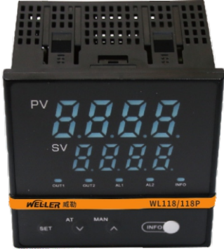
仪表型号为WL118型 面板96*96mm，开口92*92mm，插入深度110mm
