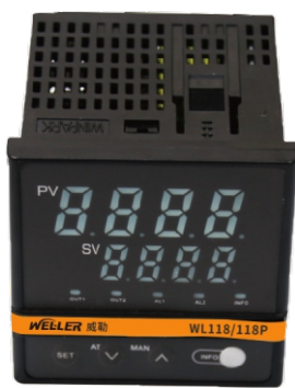
仪表型号为WL118型 面板72*72mm，开口68*68mm，插入深度95mm
